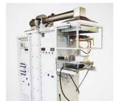
Cone Calorimeter zur Untersuchung des Brandverhaltens
